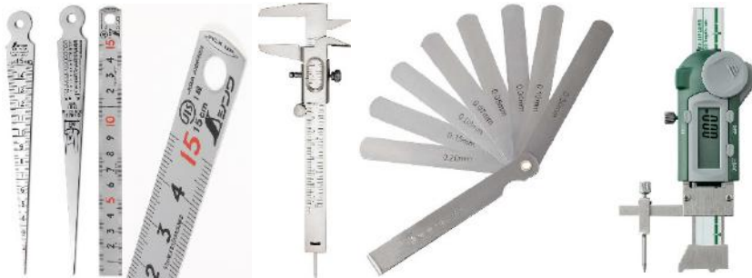
Resim 8. Kontrol fikstürlerinde kullanılan bazı ölçü aletleri
