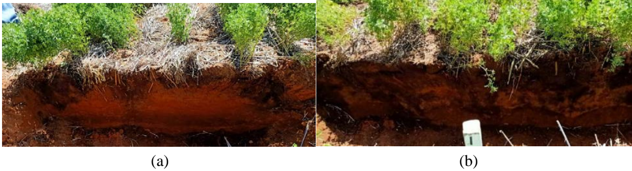
Şekil 4. pH boya indikatörü uygulanmış toprak profili (a) 9km/s ilerleme hızı; (b) 3km/s ilerleme hızı
