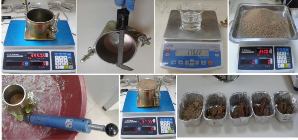
Şekil 1: Standart Proktor Deneyi Aşamaları
