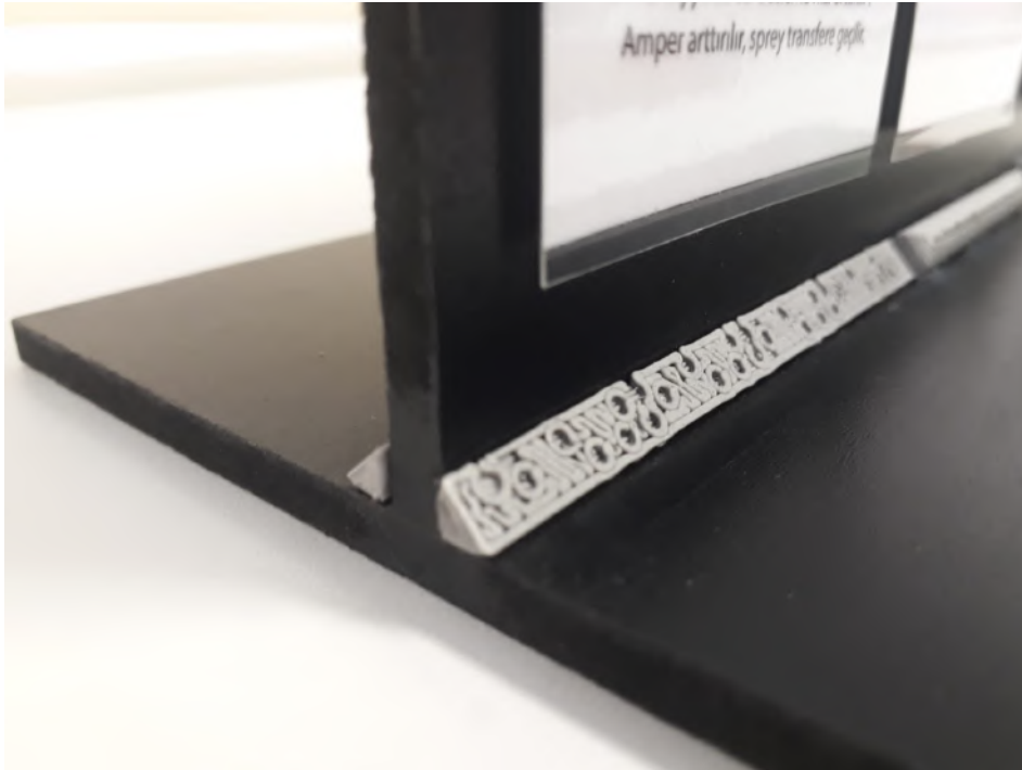
Şekil 7. PB içköşe kaynak pozisyonunda sıçrantı hatalı dikiş baskısı.
