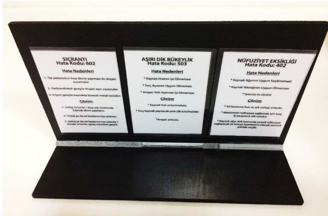
Şekil 5. PB içköşe kaynak pozisyonunda meydana gelen hatalar.
