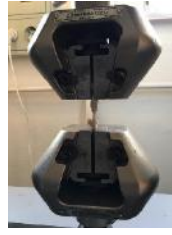
Şekil 2. Shimadzu AGS-X 1N-10 kN Elektromekanik Gerim Test Cihazı
