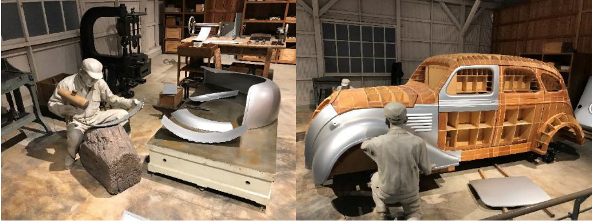
Resim 2. 1930' lu yıllarda Toyota AA modeli parça üretimi ve gövde fikstüründe kontrol
