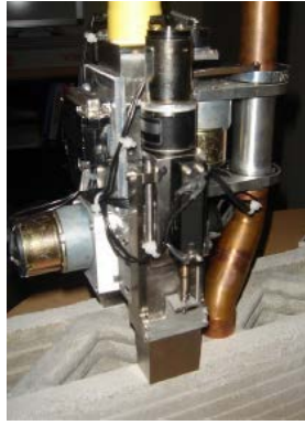
Şekil 12. 3 boyutlu beton yazıcılarla beton elemanı üreten nozzle (Khoshnevis, 2015)
