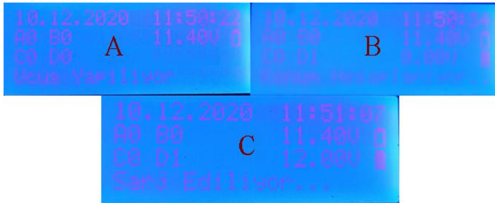
Şekil 18. Yer istasyonunun verilerinin yazıldığı ekran görüntüleri. A) ÇRİHA'nın uçuş görevinde olduğu ve batarya değeri, B) ÇRİHA'nın yer istasyonuna iniş yaptığında konumu hesaplanması C) ÇRİHA'nın şarj edildiği aynı zamanda kablosuz şarj gerilimi ile batarya gerilimini göstermektedir.
