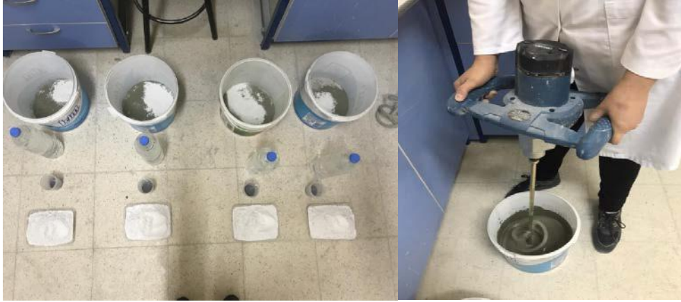
Şekil 1. Deney numunelerinin hazırlanıp karıştırılma aşaması
