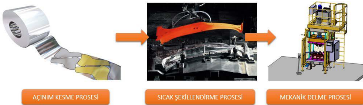
Şekil 2. Tasarılacak Mekanik Kesme-Delme Prosesi
