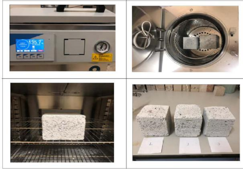
Şekil 3. Deney numunelerinin kürlenme aşaması ve nihai ürün
