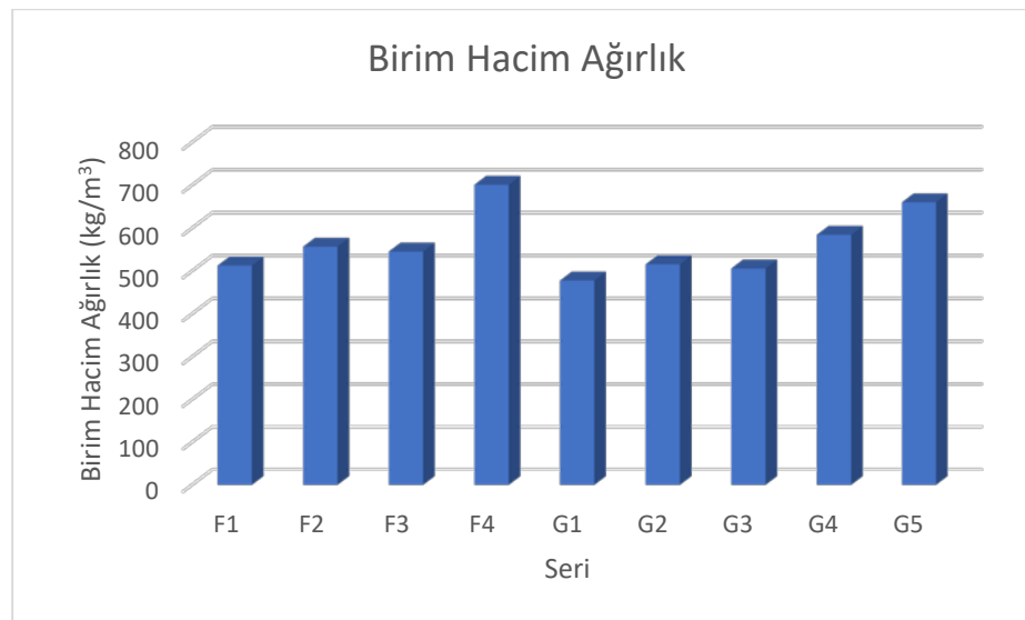
Şekil 8. Gaz beton örneklerinin birim hacim ağırlıklarının grafiksel gösterimi
