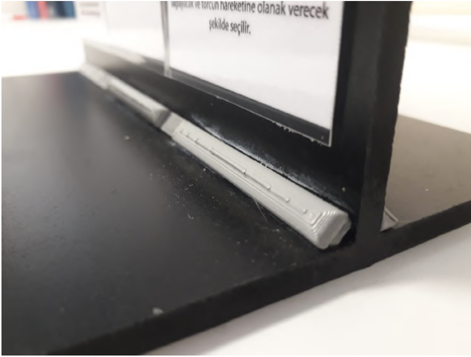
Şekil 8. PB içköşe kaynak pozisyonunda nüfuziyet eksikliği ve aşırı dışbükey hatalı dikiş baskısı.
