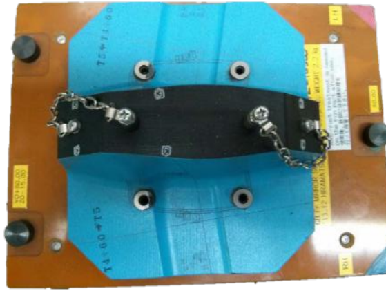
Resim 10. Polimer kompozit blok ve plastik tabla kullanılan bir fikstür
