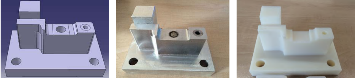
Resim 13. Farklı imalat yöntemleri ile üretilen bir fikstür örneği
