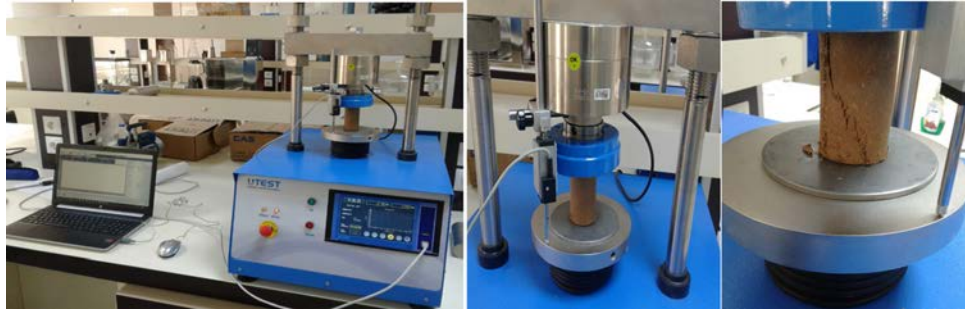
Şekil 2: Serbest Basınç Deneyi Seti ve Deney Sonucunda Oluşan Deformasyon
