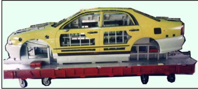
Resim 17. Taşıma arabası ile tasarlanmış fikstür örnekleri (Making Tanaka, 2020)
