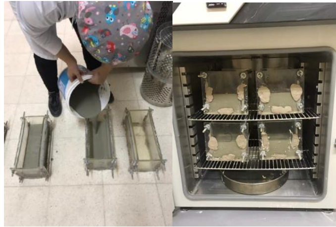
Şekil 2. Deney numunelerinin döküm ve genleşme aşaması
