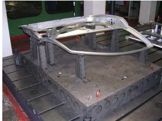
Resim 11. Geçme sac yöntemiyle tasarlanmış bir kontrol fikstürü
