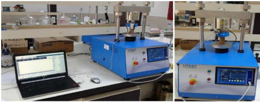
Şekil 2: Serbest Basınç Deneyi Seti
