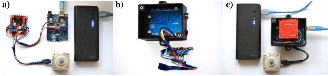
Şekil 5. Devrelerin montajı, a) Bütün devre bağlantısı, b) Arduino'nun üniteye montajı, c) Arduino ve sürücü kartının üniteye montajı.
